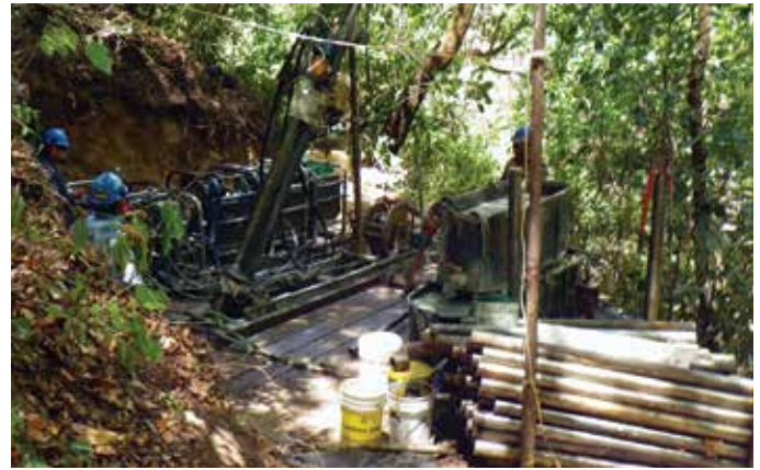
Un sitio de perforación para exploración de tamaño reducido en San Sebastián
