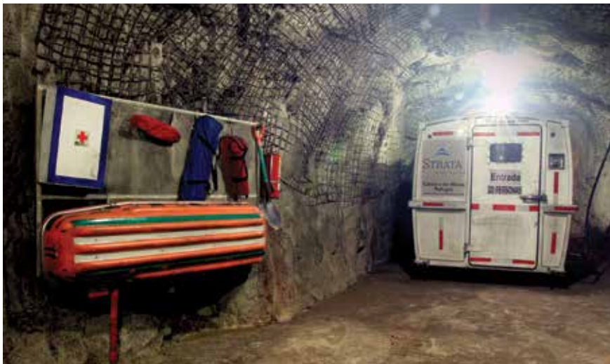
Cámara minera de rescate subterráneo en El Cubo
